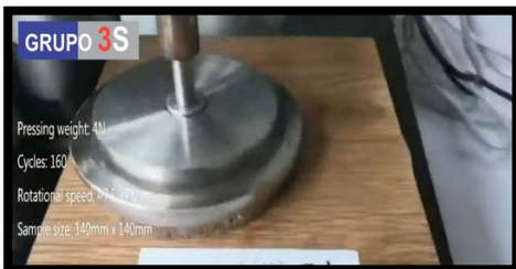
Prueba de Raspado Presión de 4 Newton Aplicada
